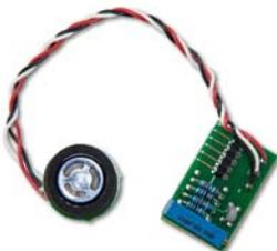
**Capteur catalytique** - Dans un capteur catalytique, les gaz et vapeurs combustibles sont oxydés (par catalyse) dans un très petit élément de chauffage, aussi connu sous le nom de « pellistor ». La chaleur qui est libérée par la réaction fait également en sorte que le pellistor augmente la température, de sorte que la résistance du fil de platine présent dans le pellistor change. Cette variation de résistance correspond à la quantité de gaz présent.
